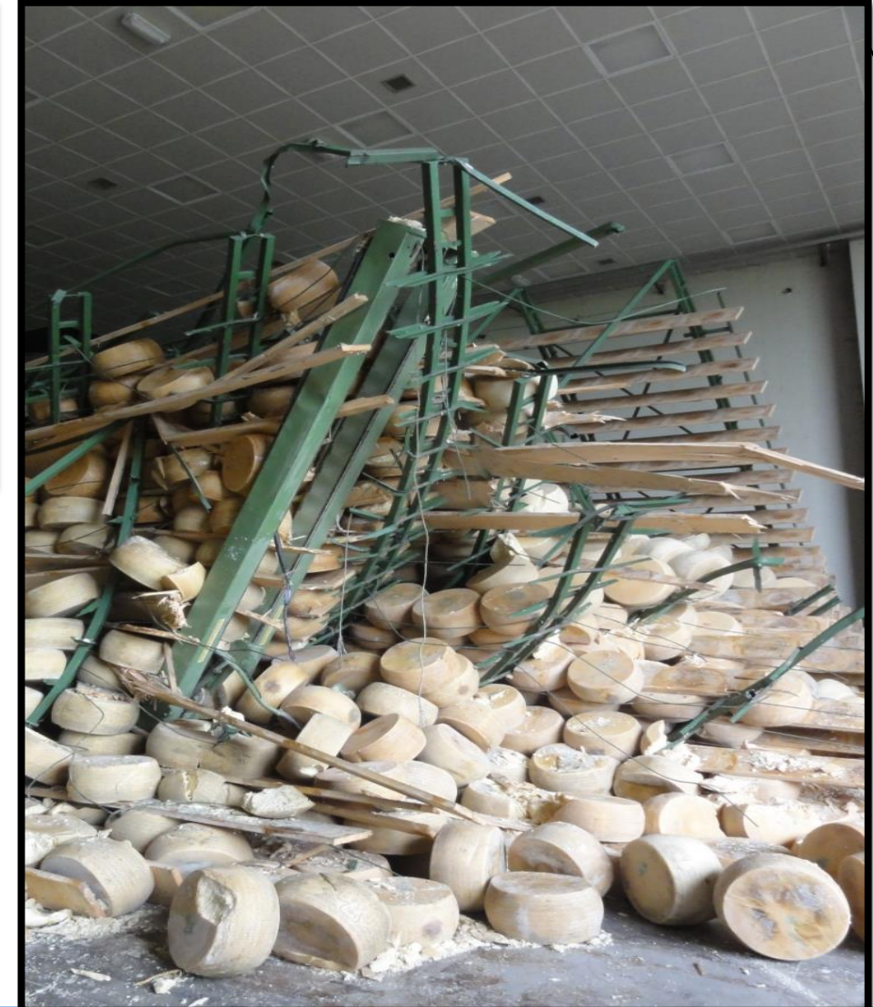
A destra: Crollo di una scaffalatura
